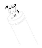
アイボルトを使用してチューブを吊り下げることもできますが、 この場合は 安全のために 2 つ目の 2 点を取り付ける必要が あります(ホルダーを併用)。
